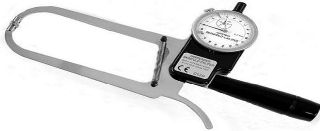
الصورة رقم 03: توضيح جهاز قياس سمك ثنايا الجسم.
